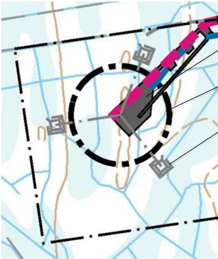
Kuva 3. Harusten perustukset sijoittuvat nostoalueen ulkopuolelle.
