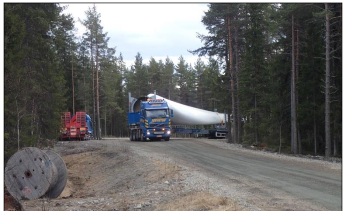
Kuva 6. (Vasemmalla) Esimerkki tuulivoimapuiston rakennus- ja huoltotiestä. Teitä käytetään muun muassa betonin, soran ja voimaloiden komponenttien kuljetuksiin sekä tuulivoimapuiston käyttövaiheessa huoltoajoihin. Maakaapeli sijoitetaan ojakaivantoon tien reuna-alueelle. (Oikealla) Tuulivoimalan osia kuljetetaan erikoiskuljetuksina. (Kuvat: Ville Suorsa / FCG).
